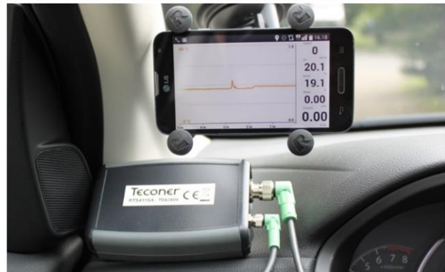
Photographie de l'interface utilisateur avec les mesures de température et le boîtier de communication Bluetooth dans le véhicule.
