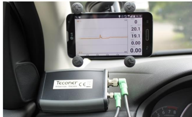
Ein Foto der Benutzeroberfläche mit Temperaturmessungen und das Gehäuse der Bluetooth-Kommunikation im Fahrzeug.
